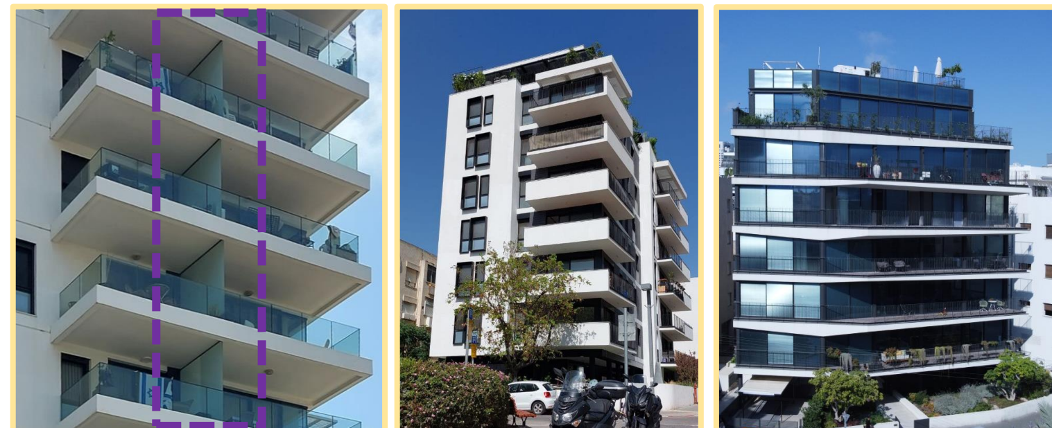
מרפסות חופפות לכל אורך החזית מעקות: ברזל, מעקה בנוי, מעקה זכוכית, קיר הפרדה מזכוכית
